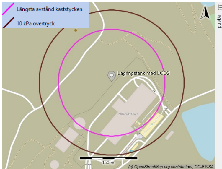
Figur 10.12: Konsekvensavstånd för tryckverkan och kaststycken på 400 kg från en BLEVE i LCO 2 -lagret vid placering 1. Ackumulatortank riskerar på
