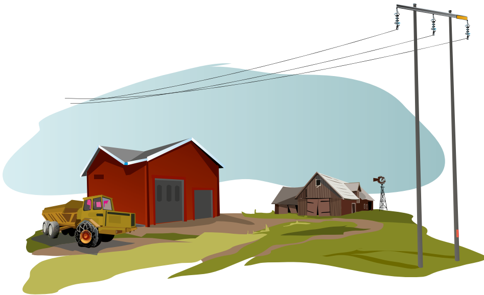
Bild 28 - Det är inte tillåtet att placera byggnader under eller nära luftledningar.
