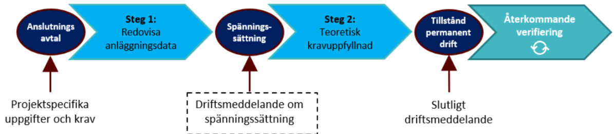
Figur 1: Schematiskt processflöde över anslutningsförfarandet av en kraftproduktionsmodul av typ B.
